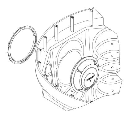
DRILL 1/4" PILOT HOLE AT REQUIRED LOCATION FROM INSIDE THE BOX
